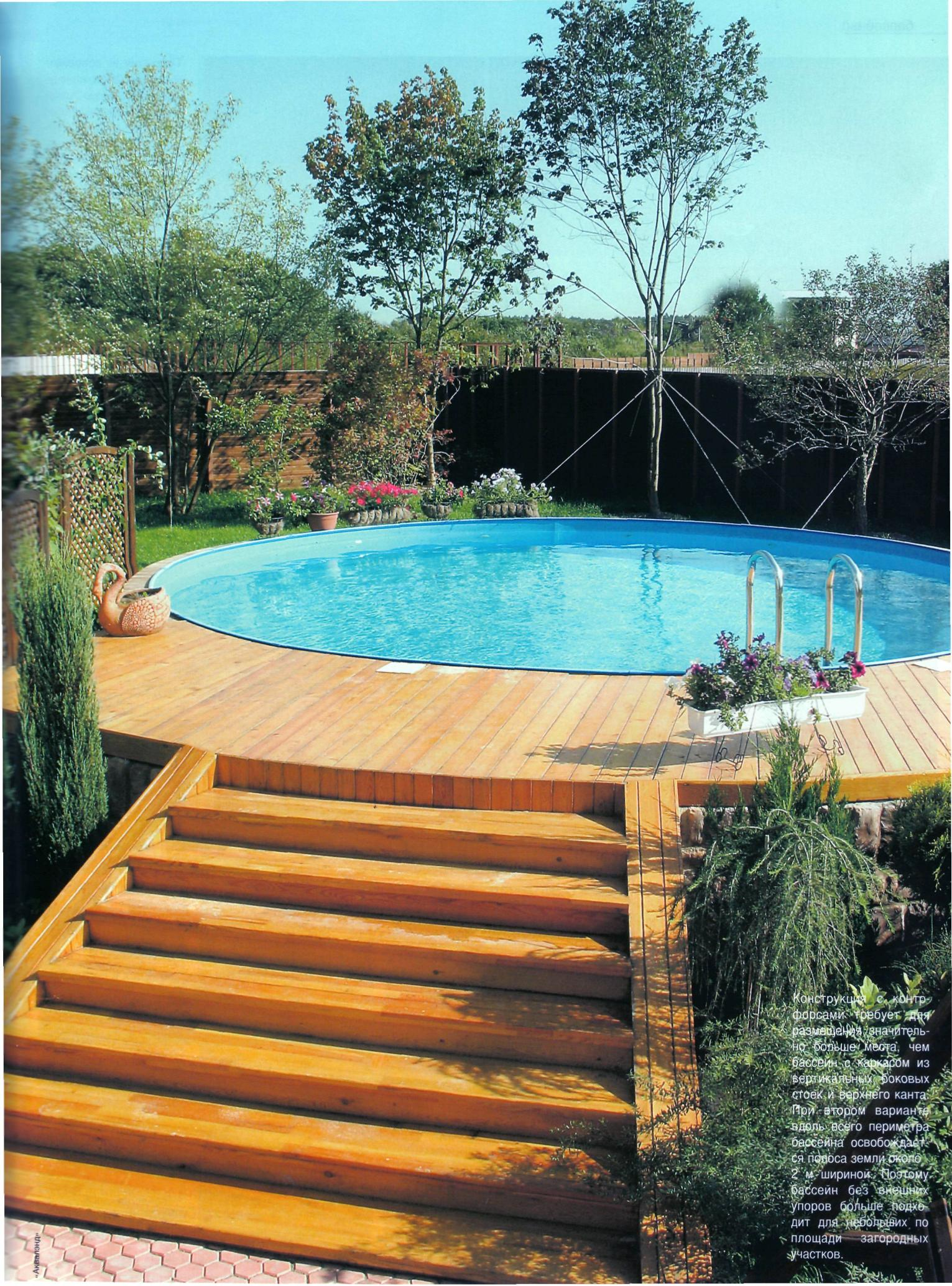
Конструкция с контрфорсами требует для размещения значительно больше места, чем бассейн с каркасом из вертикальных боковых стоек и верхнего канта. При втором варианте вдоль всего периметра бассейна освобождается полоса земли сколько 2 м. шириной. Поэтому бассейн без внешних упоров больше подходит для небольших по площади загородных участков.
